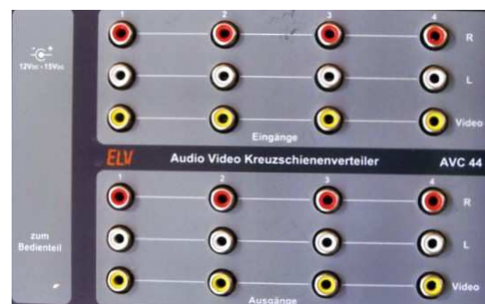
Das Anschlussfeld der Kreuzschiene benötigt geringen Platz
