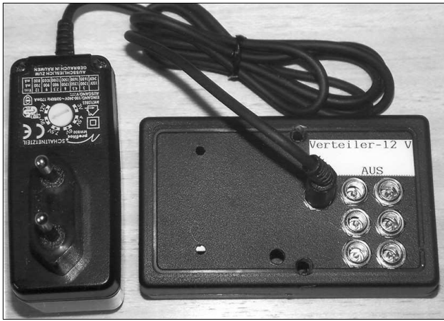
⑤ Der 12 Volt-Verteiler
